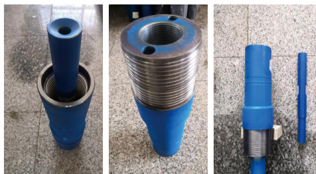
图5 套捞一体化接头及排量转换棒实物
