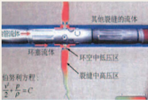
图1 水力喷射压裂原理示意图
