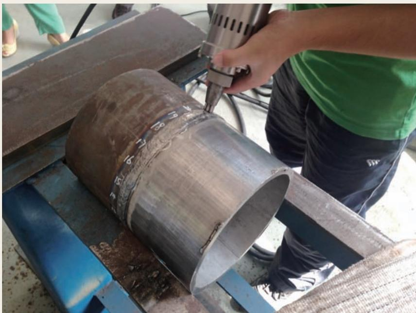
超声波消除应力试验
