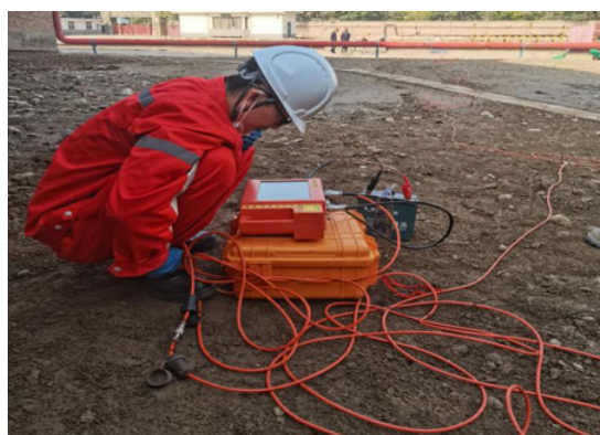
兰州石化溯源施工现场 - 高密度电法
