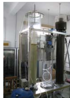
污水处理环流气浮分离塔装置
