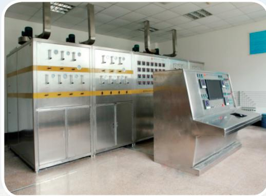
硫磺回收及尾气处理工艺及催化剂试验装置
