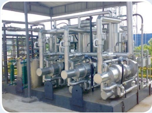
288m<sup>3</sup>/d 酸气处理硫磺回收中试装置
