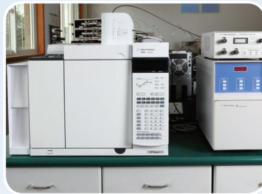
安捷伦硫化学发光形态硫检测仪
