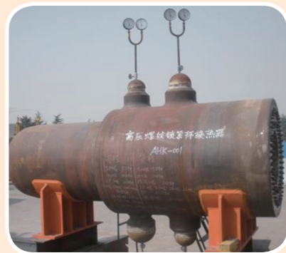
螺纹锁紧环换热器水压试验
