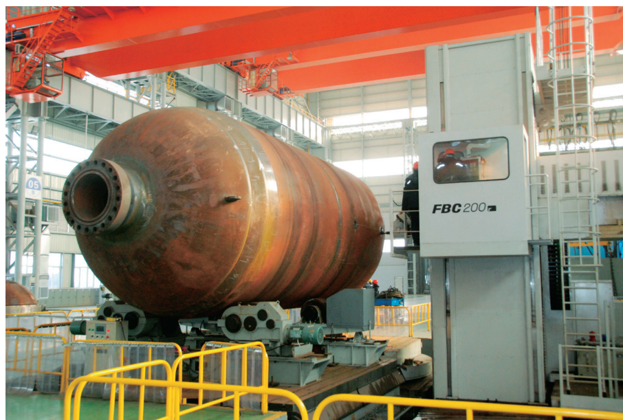
— 数控镗床加工接管坡口 —
