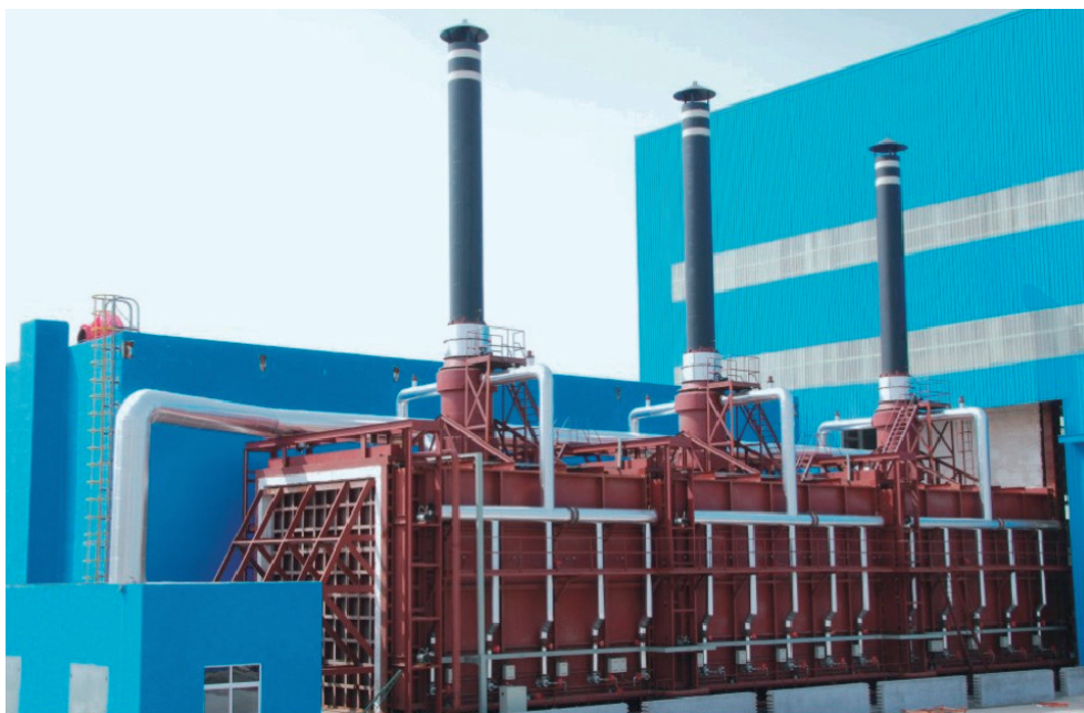
— 36mX7mX7m 台车式燃气热处理炉 —
