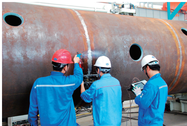
TOFD 无损检测
