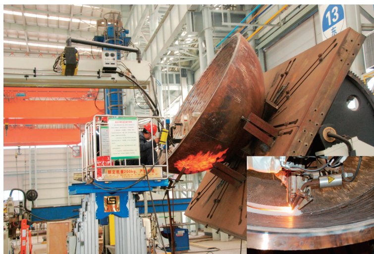
设备内壁耐蚀层带级堆焊
