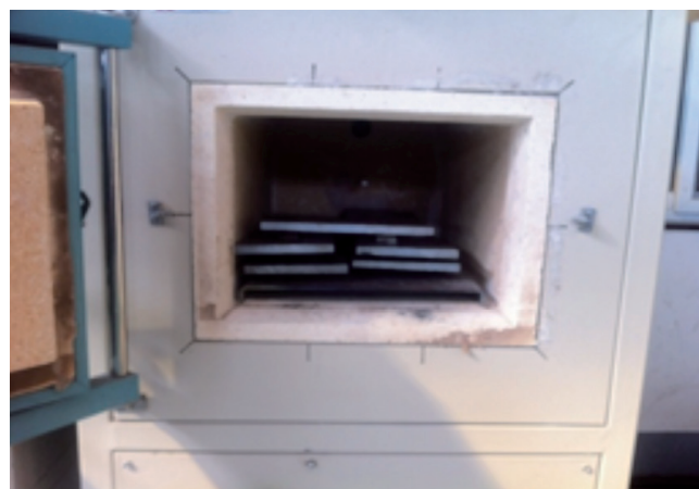
钢板复验模拟热处理试验
