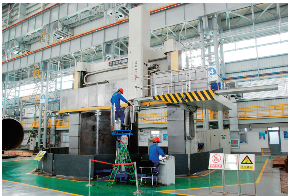
— DVT630X40 / 80Q-NC 数控双柱立式车床 —
