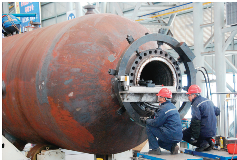
反应器法兰密封面加工研磨
