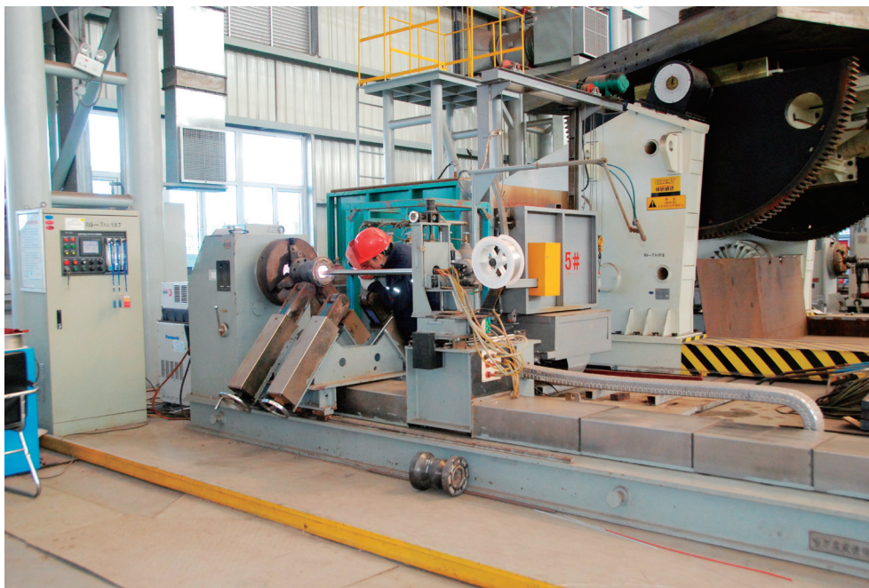
— HZU-350S 小直径直管内壁 TIG/CO 2 堆焊机 —
