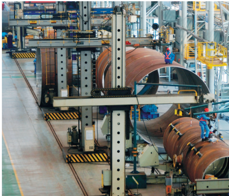
— HDS-350W 单丝窄间隙埋弧焊机 —
