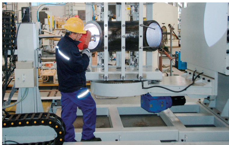
90° 弯管内壁整体堆焊
