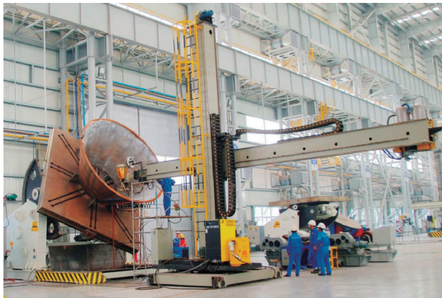
— SD6060 双带极堆焊机 100 吨变位机 —
