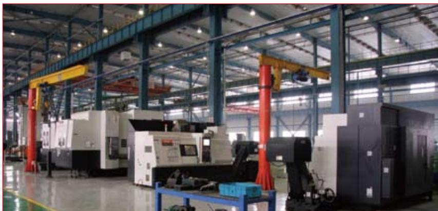
拥有卧式加工中心 FH6800、卧式加工中心 E-800v/5、车铣复合中心 intex 200- II、车铣复合中心 intex 200- III、立式加工中心 VF-5/50 等
