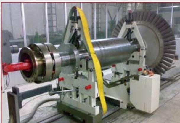
20t 转子动平衡试验机
