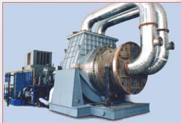
3200kW 烟气轮机试验台
