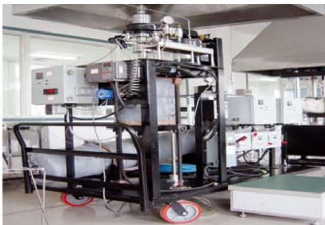
高温高压动态腐蚀评价装置
