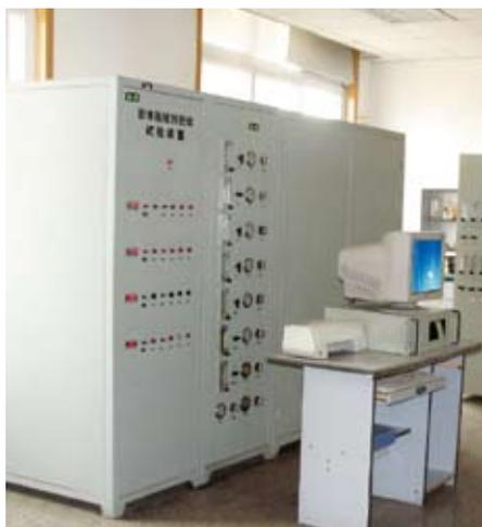
固体脱硫剂脱硫试验装置
