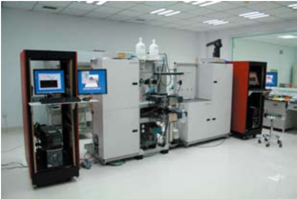
高温高压岩石电学和毛细管压力联测系统 (RCS-763Z)
