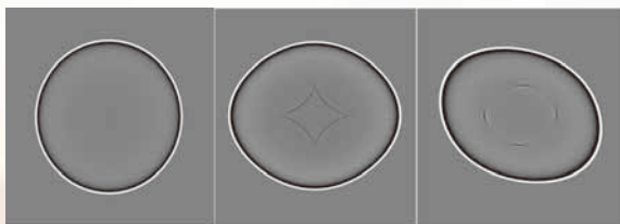
各向同性（左）、VTI（中）、TTI（右）介质中地震波前比较
