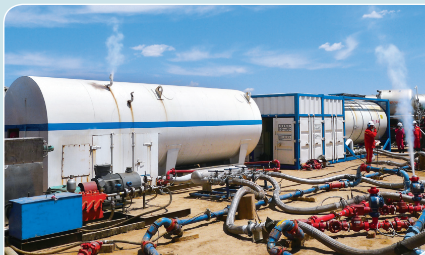
有效容积 2 \times 10\text{m}^3 的密闭混砂装置
