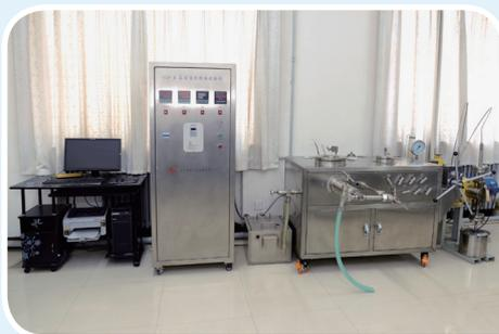
CLD- II 型高温高压动态堵漏模拟试验仪
