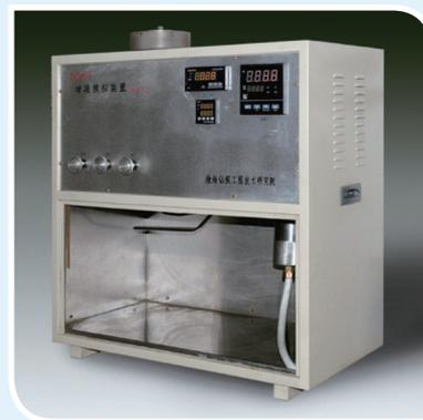
DLM-01 型静态堵漏模拟试验仪
