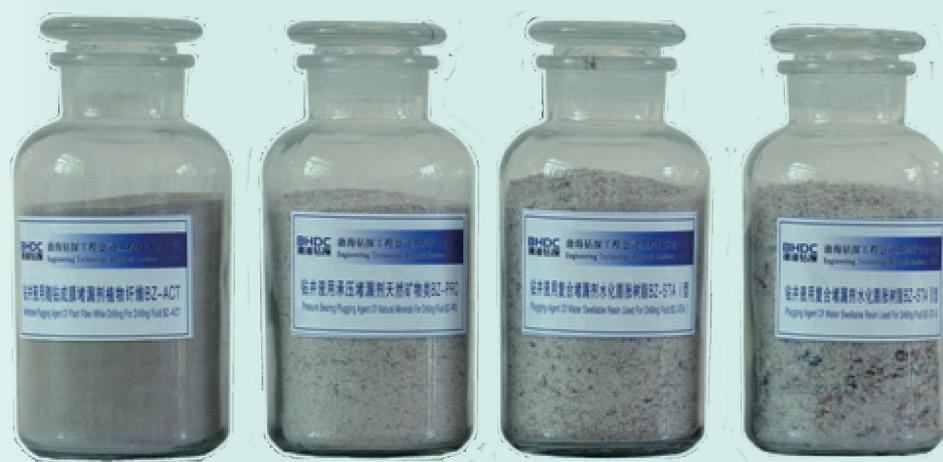
“一袋化”堵漏产品酸溶率在 75% 以上，可酸化解堵，保护油气层。
