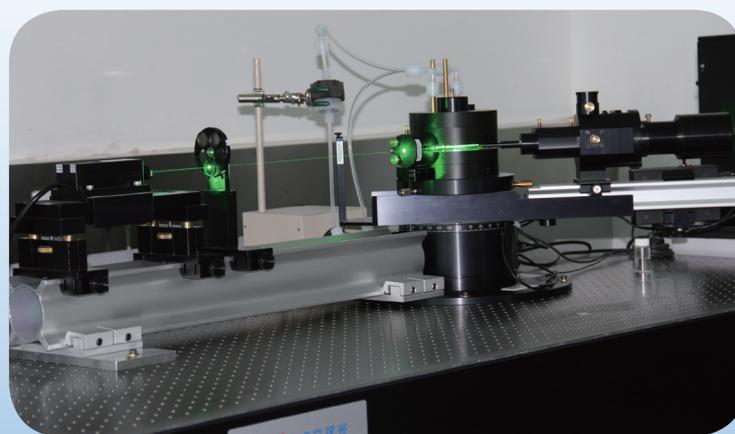
多角度激光光散射仪
