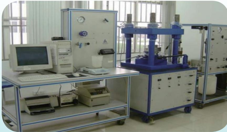
PCES-100 裂缝导流仪
