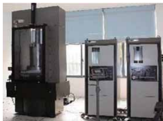
MTS-815 三轴岩石力学测试系统实物图
