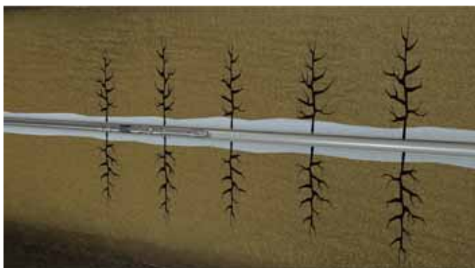
油田水力喷射压裂工艺流程示意图
