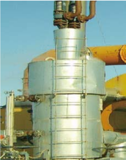
应用于哈萨克斯坦肯基亚克盐上稠油油田的高温高压汽水分离器
