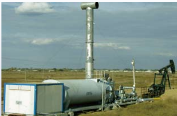
哈萨克斯坦肯基亚克盐上稠油注过热蒸汽试验现场
