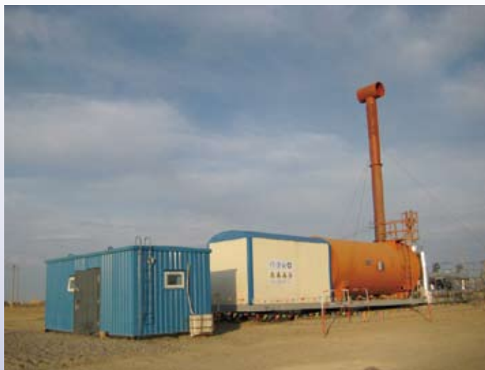
新疆油田应用的燃气过热蒸汽装置 (GW4000—ZQ/18—Q)
