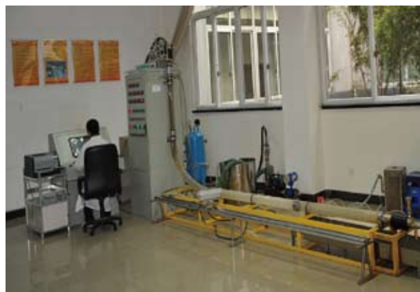
水平井可视化模拟试验装置
