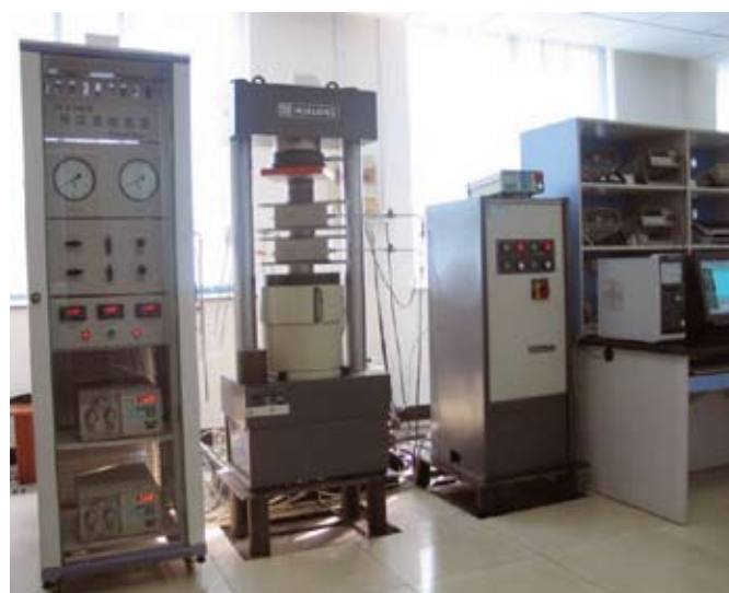
支撑剂导流实验装置
