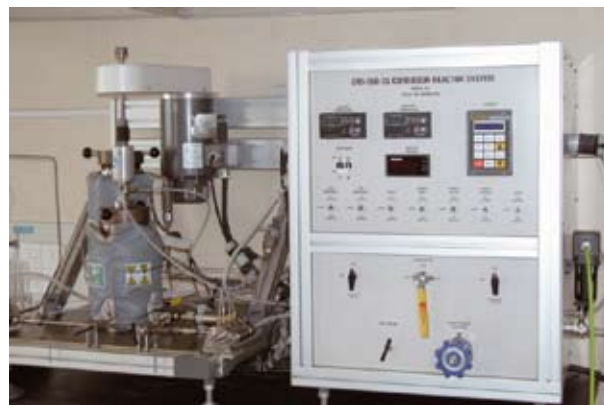
旋转圆盘酸岩反应实验装置
