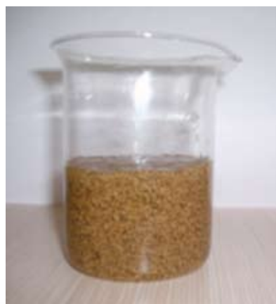
羧甲基瓜胶压裂液悬砂性能
