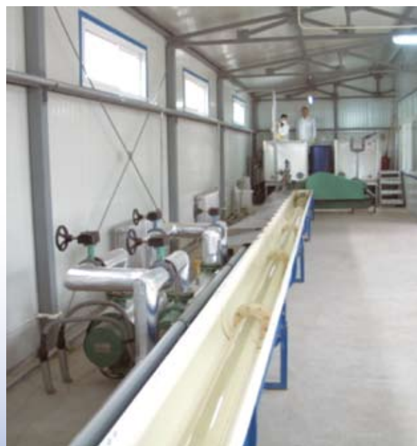
大型透明管路水平井液体流态模拟研究物模
