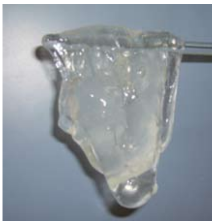
羧甲基瓜胶压裂液挑挂性能
