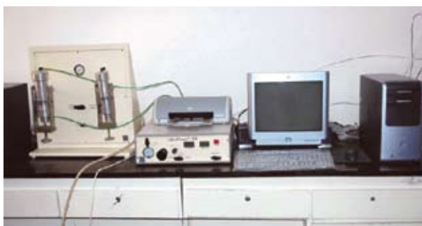
UltraPeamTM-400 渗透率测试系统
