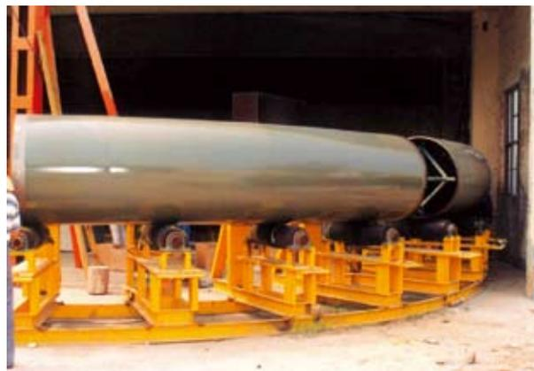
弯管外防腐作业线
