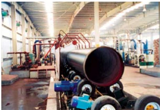
钢管外防腐作业线
