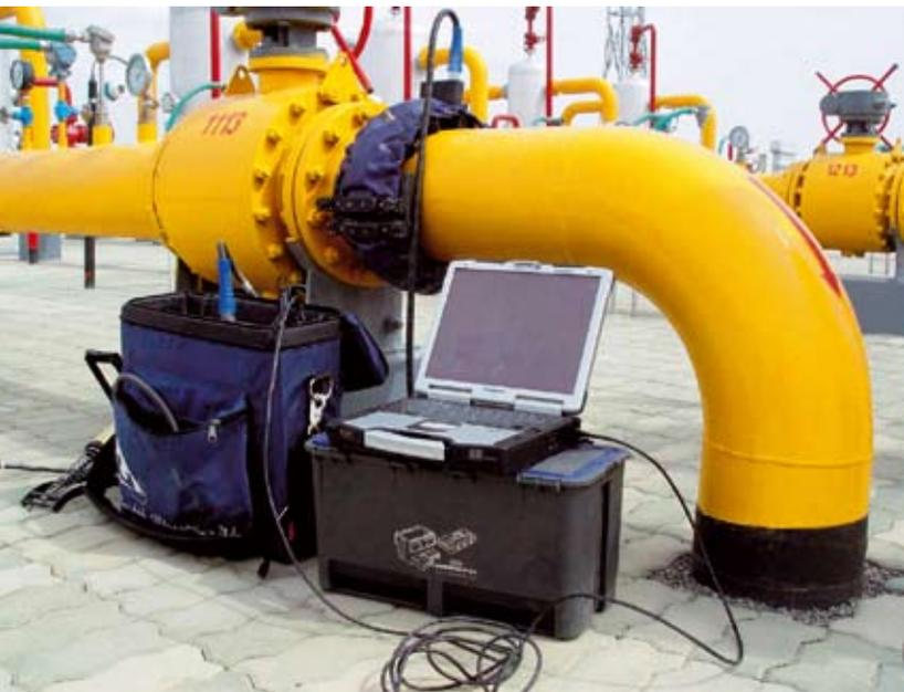
利用超声导波检测设备对管道站场管道缺陷进行检测
