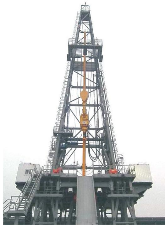
北石 DQ70BSC 型顶驱装置现场作业（四川）
