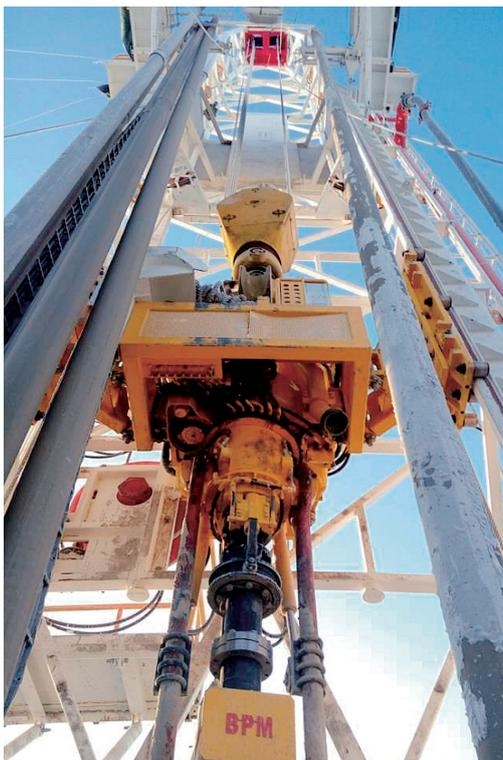
北石 DQ40BSG 型顶驱装置现场作业（大庆）
