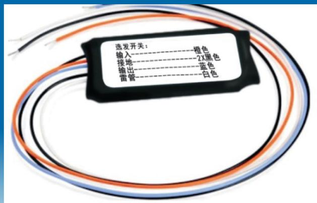
电子式多级点火控制器
