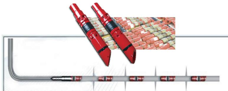
易钻复合材料桥塞分段系统结构示意图
