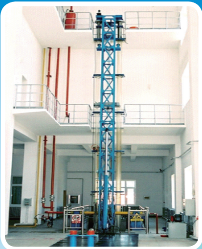
油—气—水三相流动实验与标定装置
