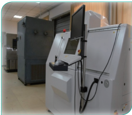
微焦点 X 射线焊点检查系统
