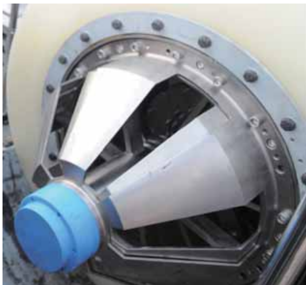
图 2-6 速度控制系统泄流装置打开
