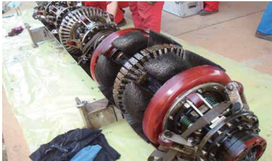
图 3-1 \phi 711 管道智能检测器
