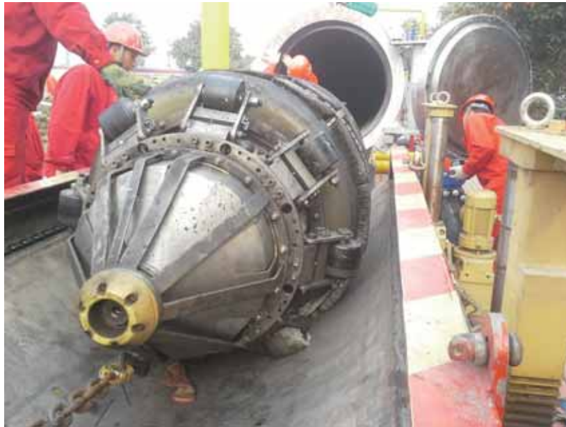
图 3-4 \phi 1016 三轴管道智能检测器
