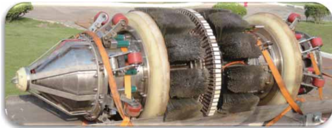
图 2-5 搭载速度控制系统 \phi 1016 三轴漏磁腐蚀检测器
