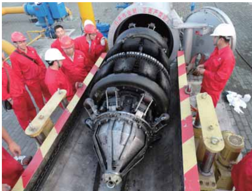
图 3-3 \phi 1016 三轴管道智能检测器
