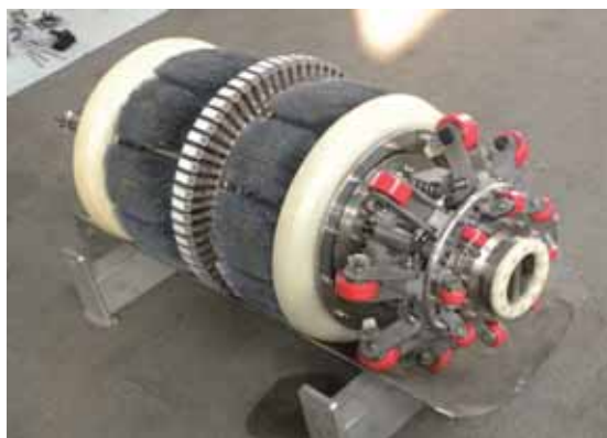
图 2-4 \phi 711 三轴管道智能检测器
