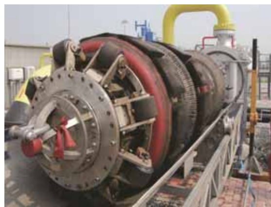
图 2-1 \phi 1016 管道智能检测器
