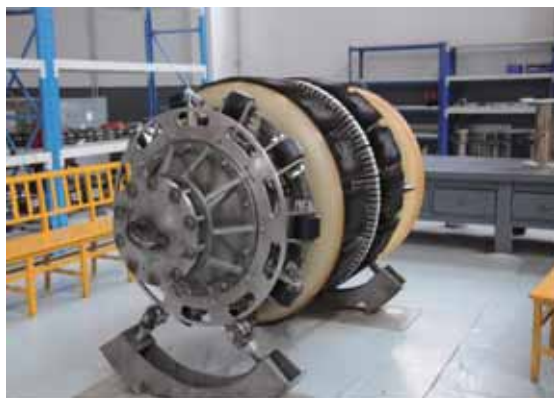
图 2-3 \phi 1219 三轴管道智能检测器
