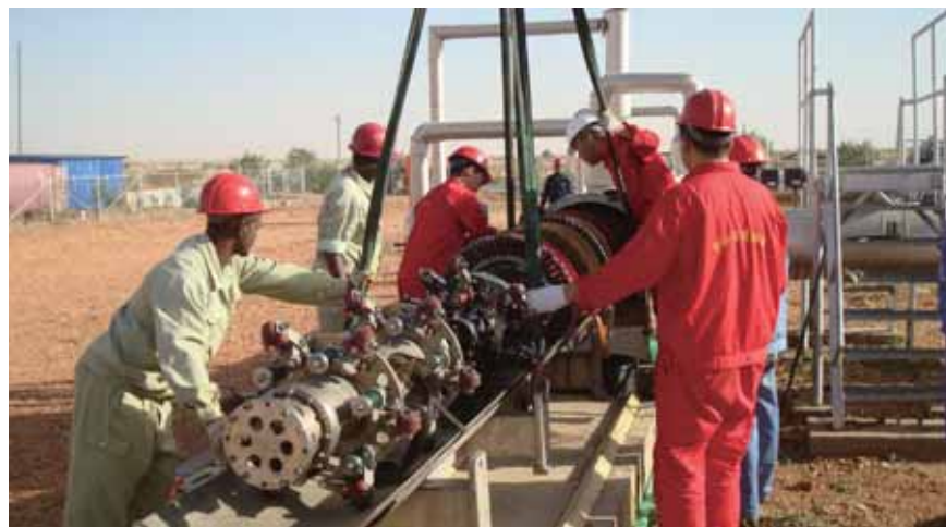
图 3-2 \phi 711 管道智能检测发球
