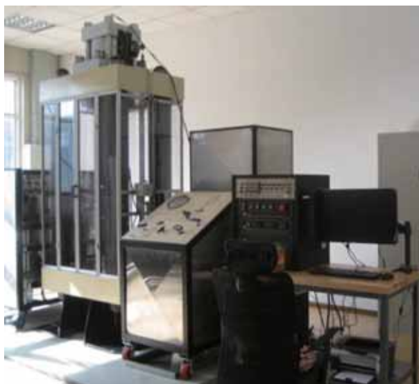
TerraTek 4010 型岩石三轴实验机
