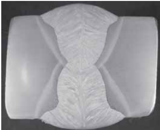
x80 焊缝宏观照片 (焊缝形貌规整, 过渡平滑)
