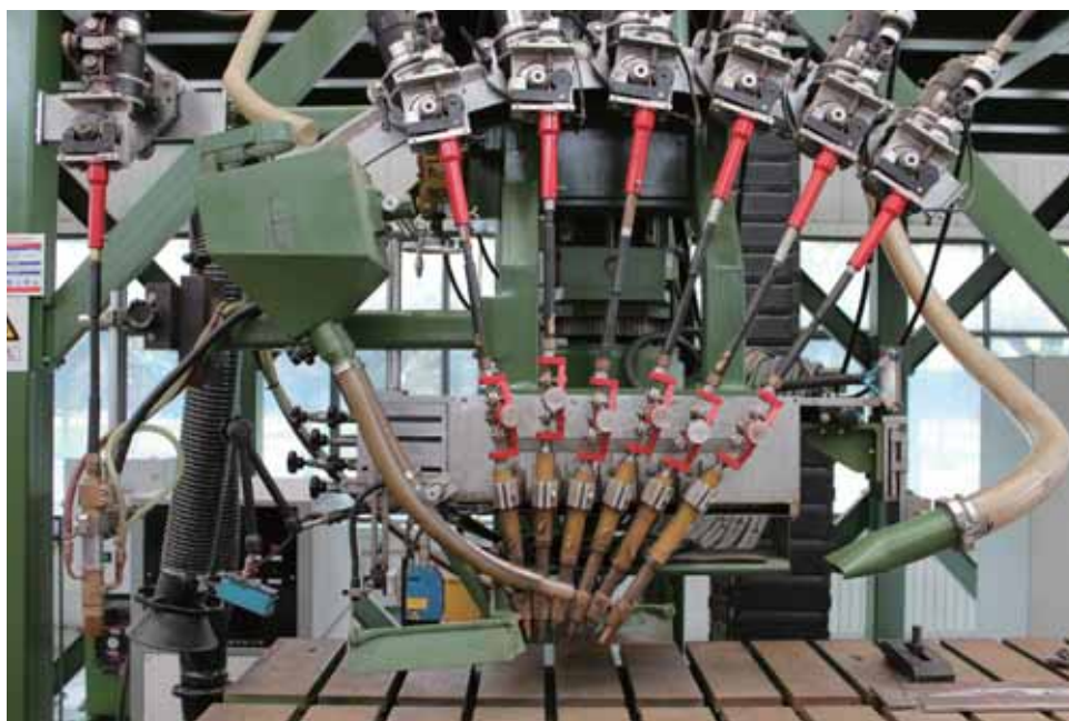
数字化焊接试验装置
