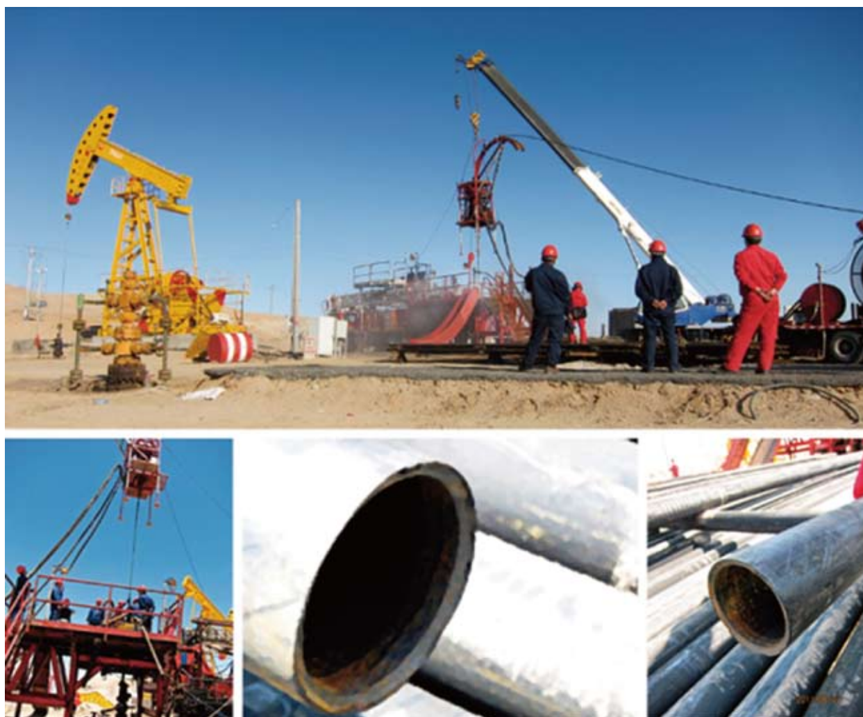
青海油田连续管水力切割油管作业
