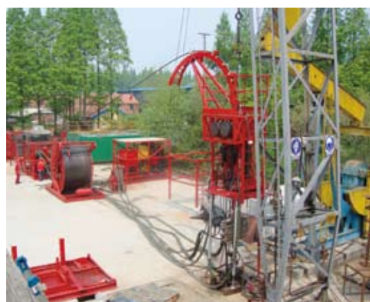
设备出厂调试专用的试验井场
