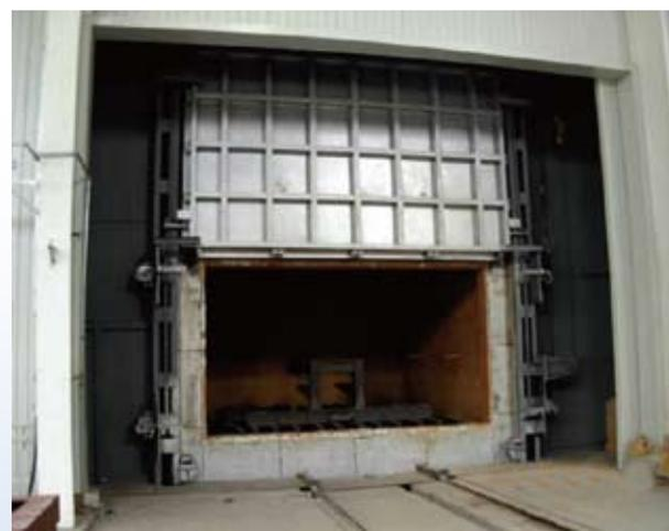
坯料加热炉
