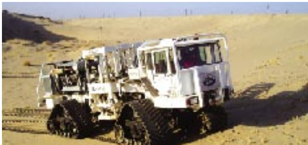
Vehículo vibrador oruga KZ-30 desarrollado por la CNPC.
