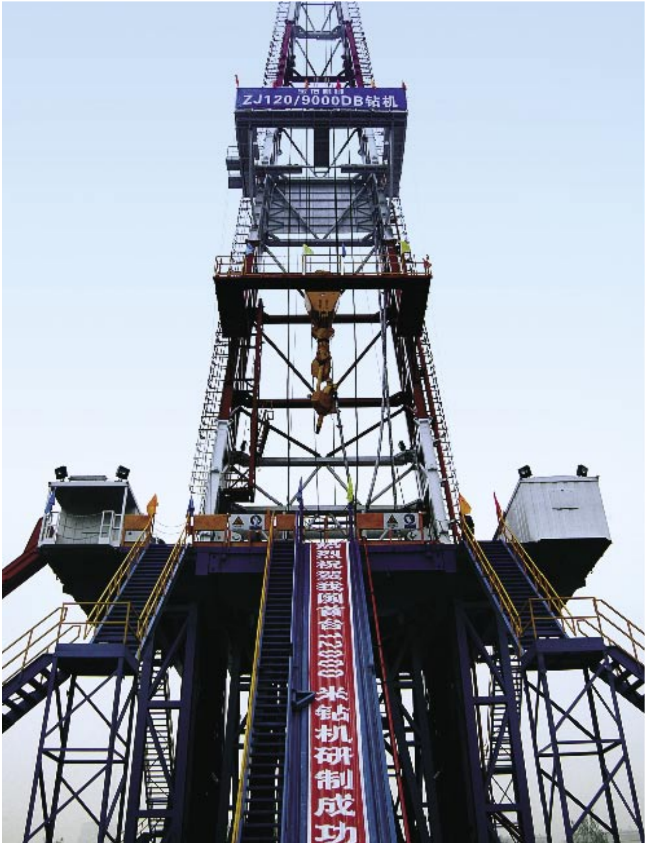
Perforadora de pozos ultraprofundos, desarrollada y producida de manera autónoma por la Corporación, tiene una capacidad nominal de perforación de 12.000 metros.
