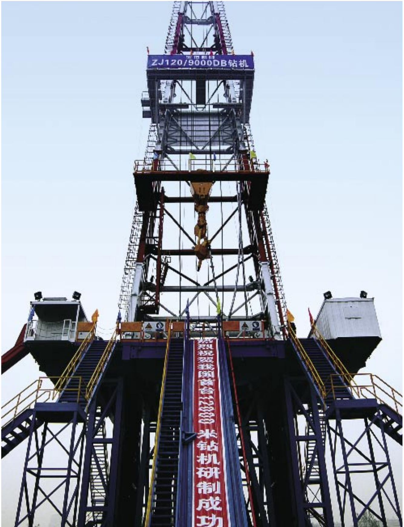
La CNPC a développé indépendamment une foreuse pétrolière à grande profondeur. Elle peut atteindre 12 000 mètres de fond.
